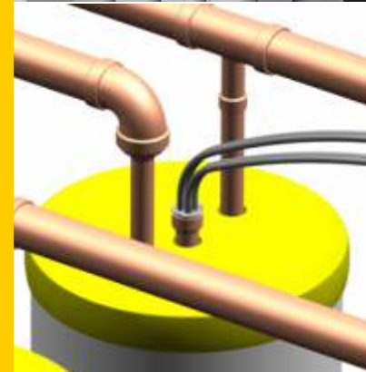
LWZ mit Fühlerrohr
